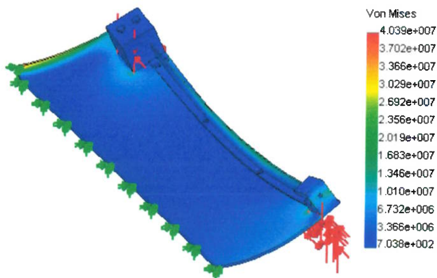
Figura 61: Tensões na estrutura com reforço "T"
