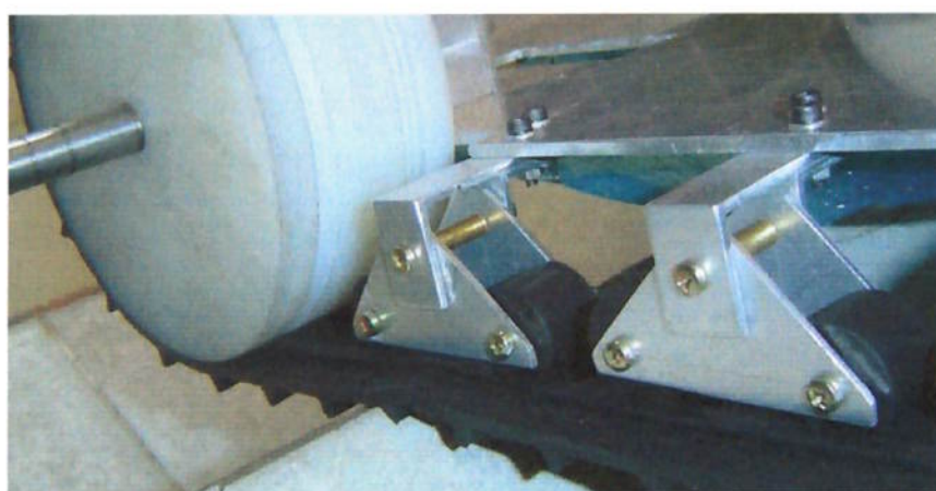
Figura 19: Detalhe do sistema atuando (obstáculo: escadas)
