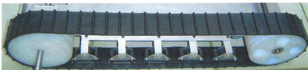
Figura 18: Montagem final dos esticadores no protótipo
