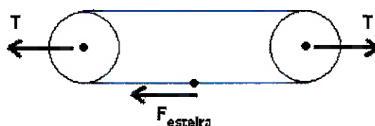
Figura 11: Esquema do sistema de esteiras - forças atuantes
